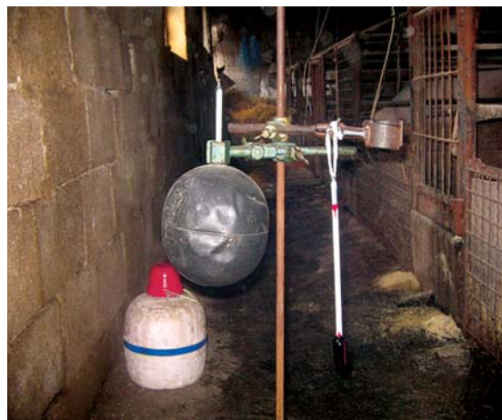
Слика 1. Поставеност на мерните инструменти во средишниот дел на ходникот за манипулација во прасилиштето
